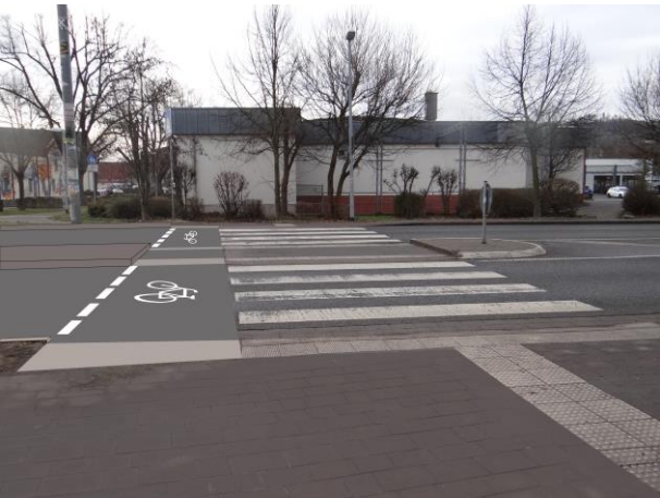
● Abbildung 31: Entwurf zur Rad-Furt am Kreisverkehr.
