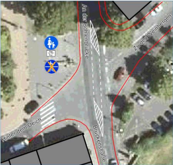
● Abbildung 31: Entwurf zur Rad-Furt am Kreisverkehr.
